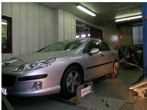
Sur le banc à rouleaux, le véhicule suit ce qu'on appelle un "cycle de conduite", c'est-à-dire que sa vitesse varie, en fonction du temps, selon un mode déterminé par une directive européenne : tant de km à telle vitesse en cycle urbain, puis tant de km à telle vitesse en cycle extra-urbain. Voici la représentation graphique de la vitesse en fonction du temps :
